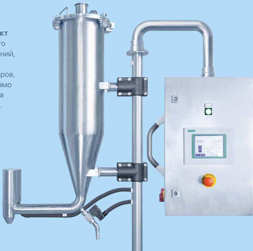
Теперь легко организовать розлив воды с натуральными вкусовыми добавками и витаминами. Для этого достаточно установить на линии розлива воды **АРОМАинжект**, который будет впрыскивать заданную дозу жидкого ароматизатора или добавки в каждую бутылку прямо в процессе розлива. Чтобы поменять ароматизатор или вкусовую добавку, достаточно промыть **АРОМАинжект** (например, озонированной водой) и заполнить его новым вкусом.
